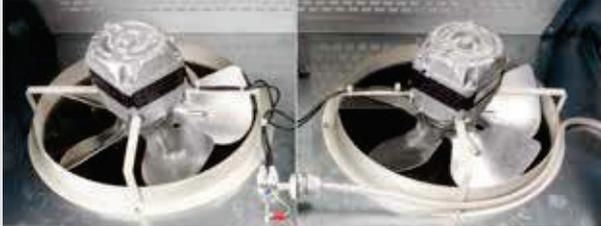
Zwei thermostatisch gesteuerte Abluftventilatoren sorgen für optimale Kühlung des Kompressors.
