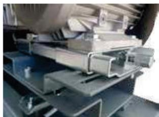
Vibrationsarm: Die Verdichtereinheit ist durch elastische-Lager kpl. vom Gehäuserahmen entkoppelt
