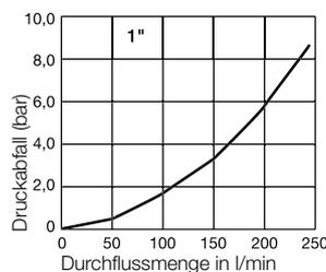
**Hinweis:** Dargestellter Druckabfall und Berstdruck am Überdruckventil werden für den Gesamtdruckabfall addiert.
