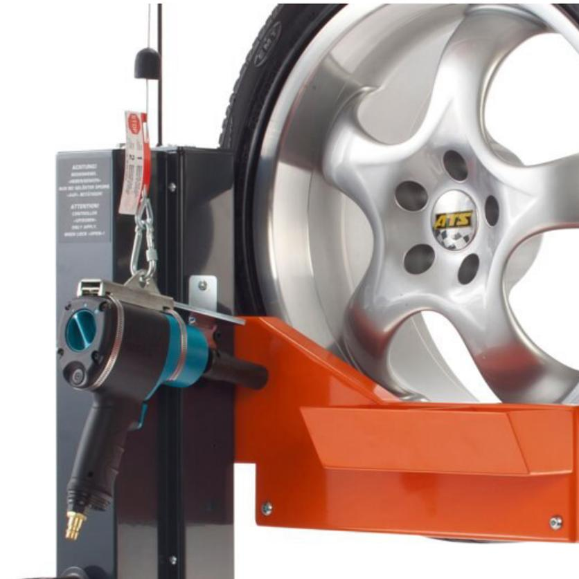
Ein Galgen mit Balancer ermöglicht das ermüdungsfreie Arbeiten mit dem Schlagschrauber am Rad.
