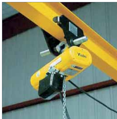
Elektrokettenzug, klein und leicht, für eine Vielzahl von Anwendungsfällen.
